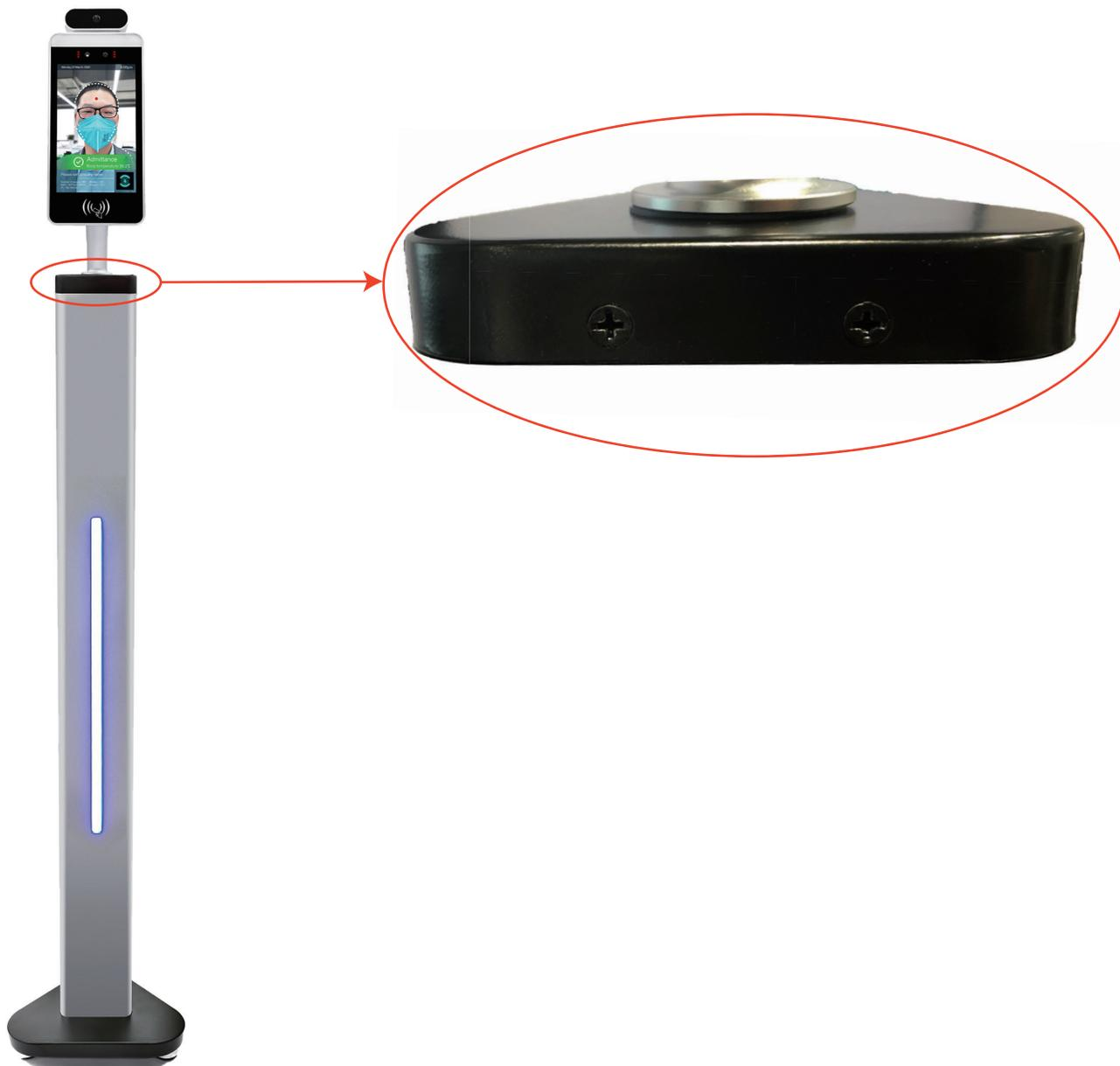
② ゲートヘッド下部のナットを緩め、ケーブルをナットに通し、ナットを外してください。
